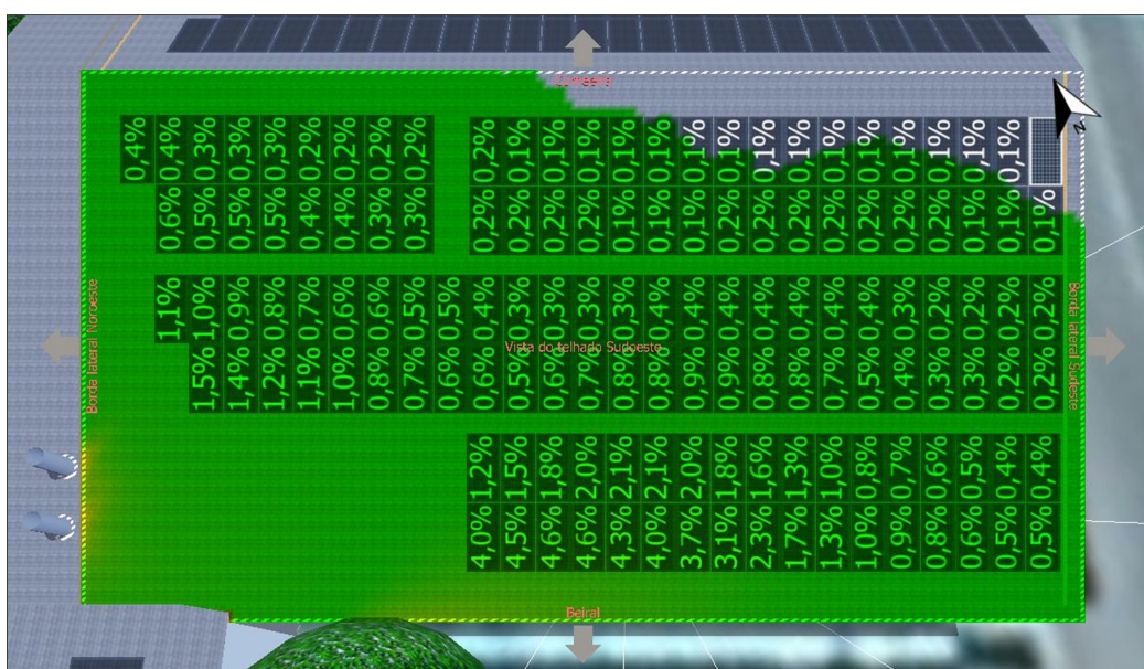
Figura 2.18 - Frequência de sombreamento na área sudoeste do supermercado
