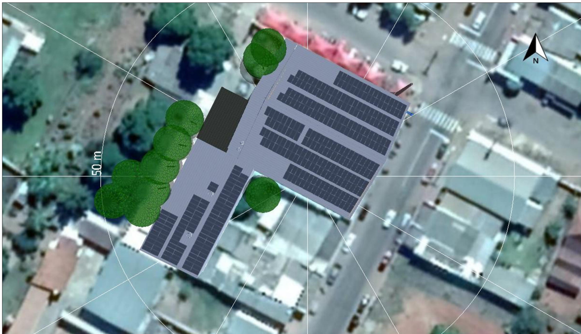
Figura 2.12 - Disposição dos módulos no telhado do supermercado
