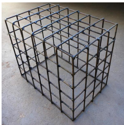
Figura 31 – Gaiola de Faraday Final em miniatura.
