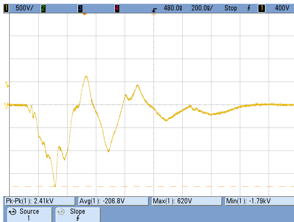
Figura 42 – Tensão de Passo – Gaiola de Faraday
