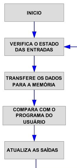
Figura 4 - Fluxograma de operação de um CLP.
