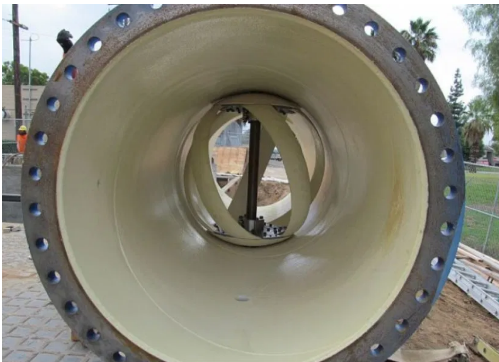
Figura 11 - Foto interna da turbina da LucidPipe.
