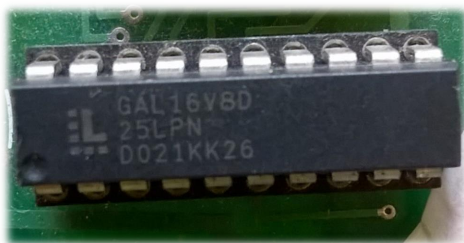
Figura 11. Foto do PLD no circuito do inversor
