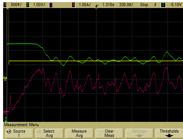
Figura 28 – Resposta a um degrau de posição em torno do ponto de linearização da planta.
