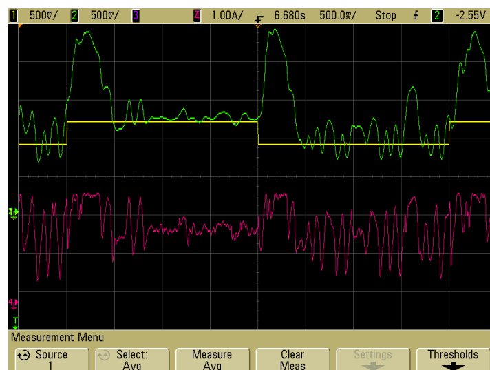
Figura 29 – Resposta do sistema para uma aproximação de 5mm ao eletroímã, em relação ao ponto de linearização.
