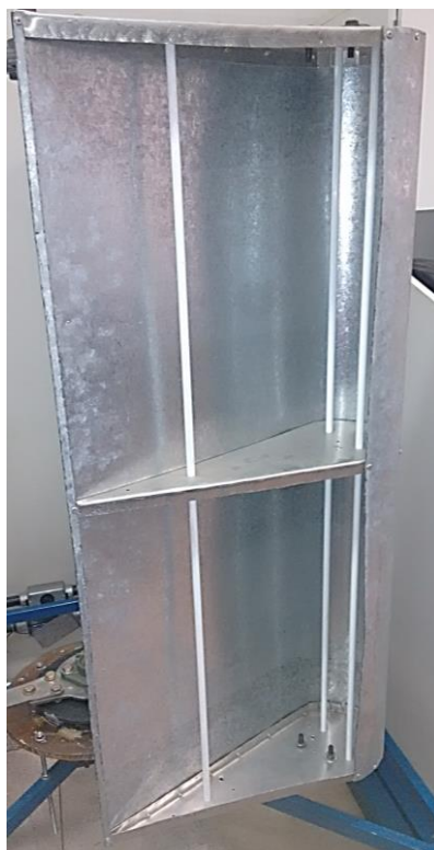
Figura 3.15 Perfil da asa do aero gerador Lenz2 da ECOA.
