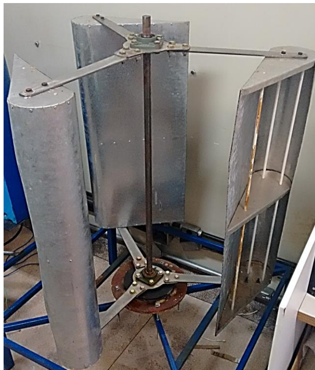
Figura 3.16 Rotor do protótipo da turbina Lenz2 com 3 pás.
