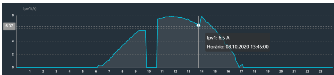
Figura 3.8 Corrente de saída dos módulos segundos antes da limpeza
