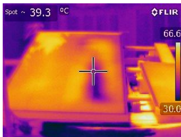
Figura 5.4 Imagens térmicas do painel após colocar água na bandeja, analisando a temperatura originada na região onde estava a bandeja e na região lateral
