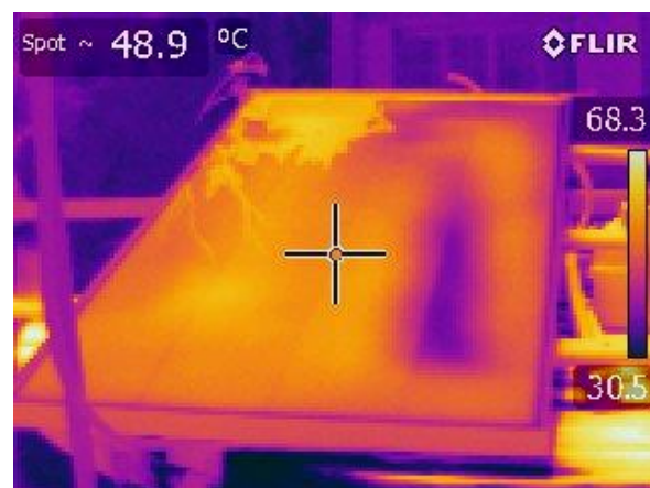
Figura 5.4 Imagens térmicas do painel após colocar água na bandeja, analisando a temperatura originada na região onde estava a bandeja e na região lateral
