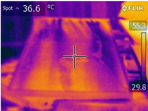
Figura 5.2 Fotos térmicas da placa fotovoltaica em condições limpas pelo profissional e limpa pelo sistema
