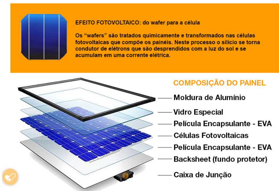
Figura 2.5 Composição de um painel fotovoltaico
