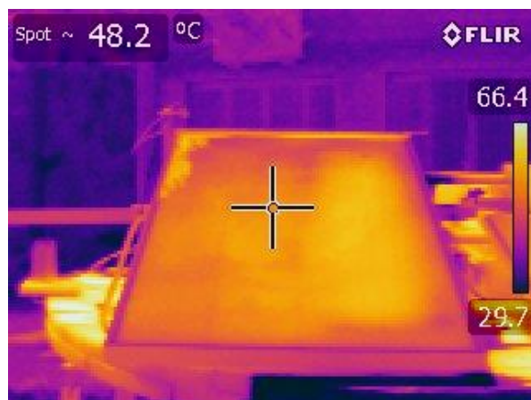
Figura 5.3 Imagens térmicas do painel com bandeja instalado sob o mesmo, analisando temperatura na região onde foi instalada a bandeja e na região lateral
