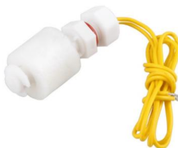
Figura 4.19 Imagem de sensor de nível de água vertical
