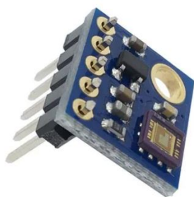
Figura 4.20 Transdutor de Radiação Ultravioleta - UV ML8511
