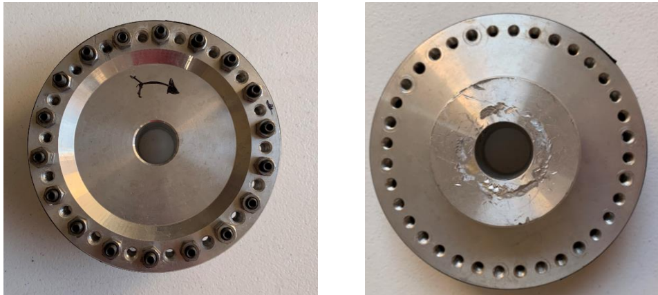
Figura 35 – Massa de 900g para simular carga acoplada ao rotor do MIT.
