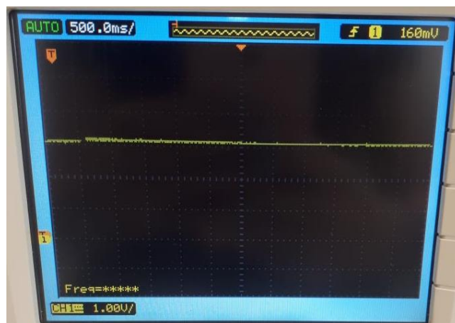
Figura 4.3 Tensão de saída do Dobrador de Tensão.
