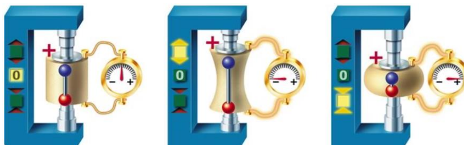
Figura 2.3 Efeito direto da Piezoelectricidade.
