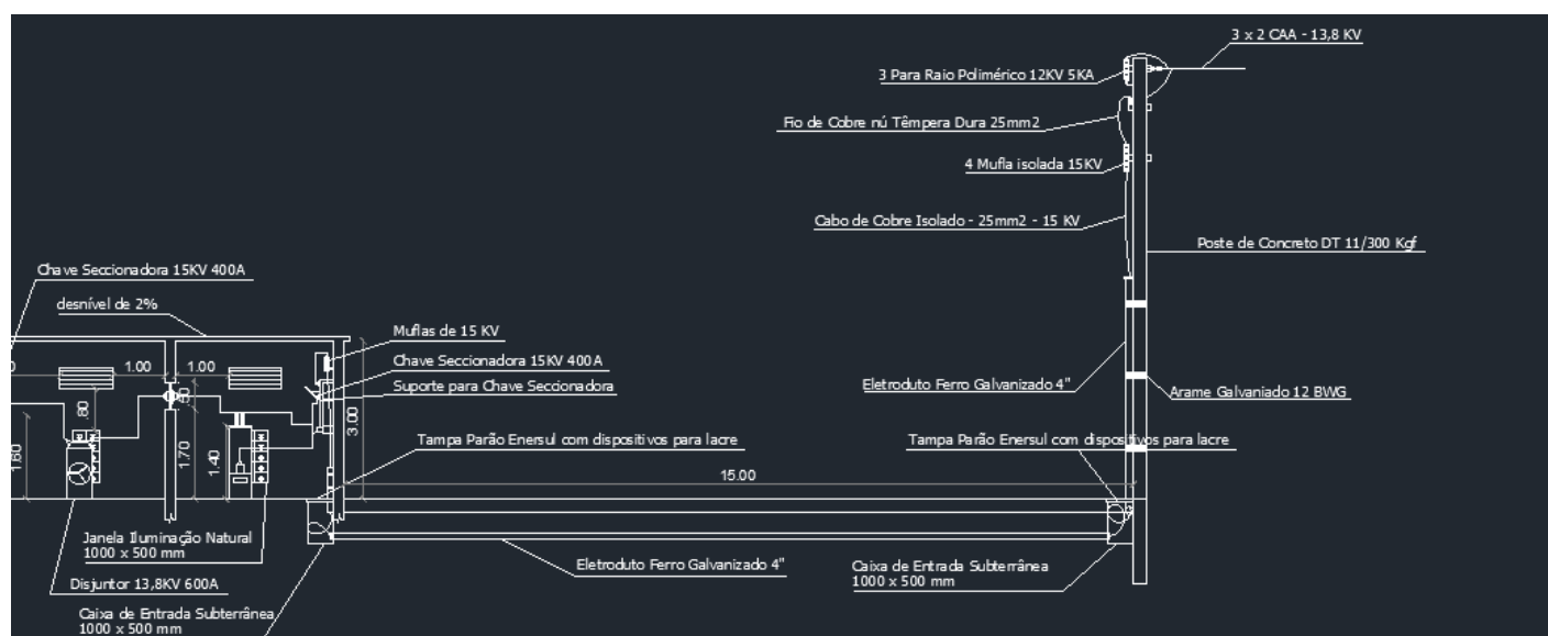
Figura 31 - Vista lateral do ramal de entrada
