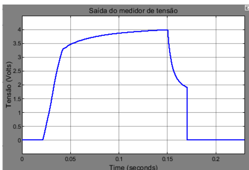
Figura 4.12 Tensão no capacitor de alta tensão com destaque no carregamento do mesmo, t [s] x V [V]
