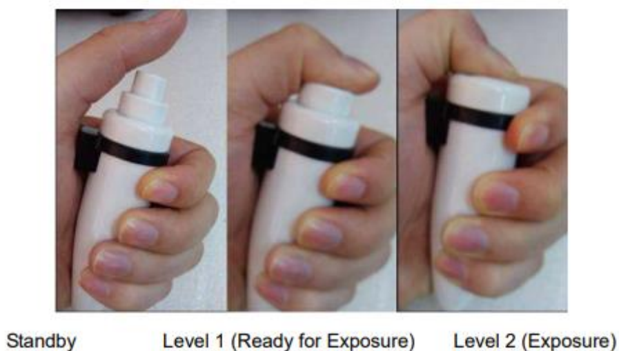
Figura 2.16 Etapas do disparador de Raio X
