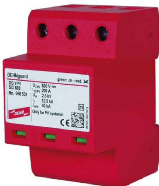
Figura 3.8 DPS DEHNguard - Especificações do modelo
