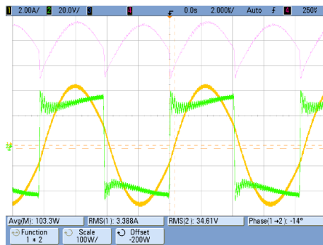
(a) Medições na saída do inversor.
