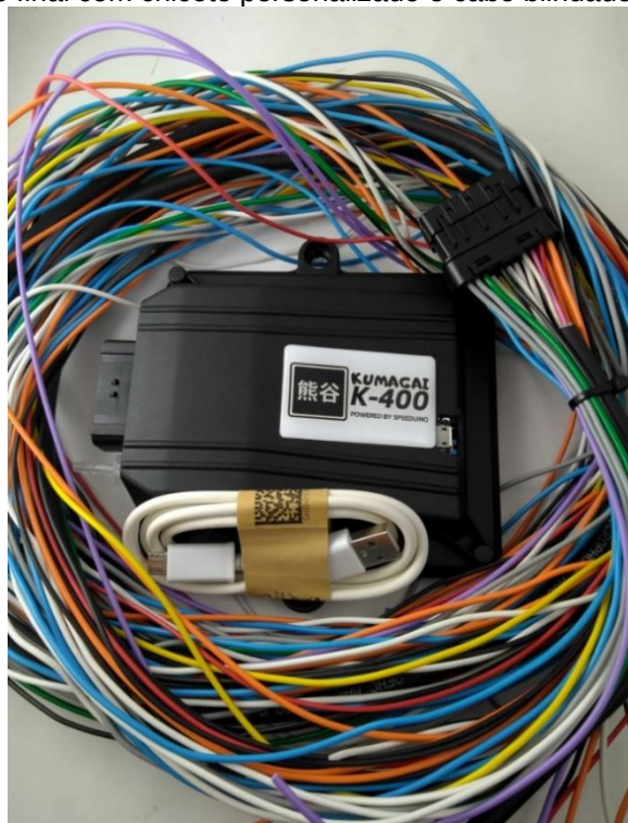
Figura 50 – Produto final com chicote personalizado e cabo blindado no sinal de rotação.
