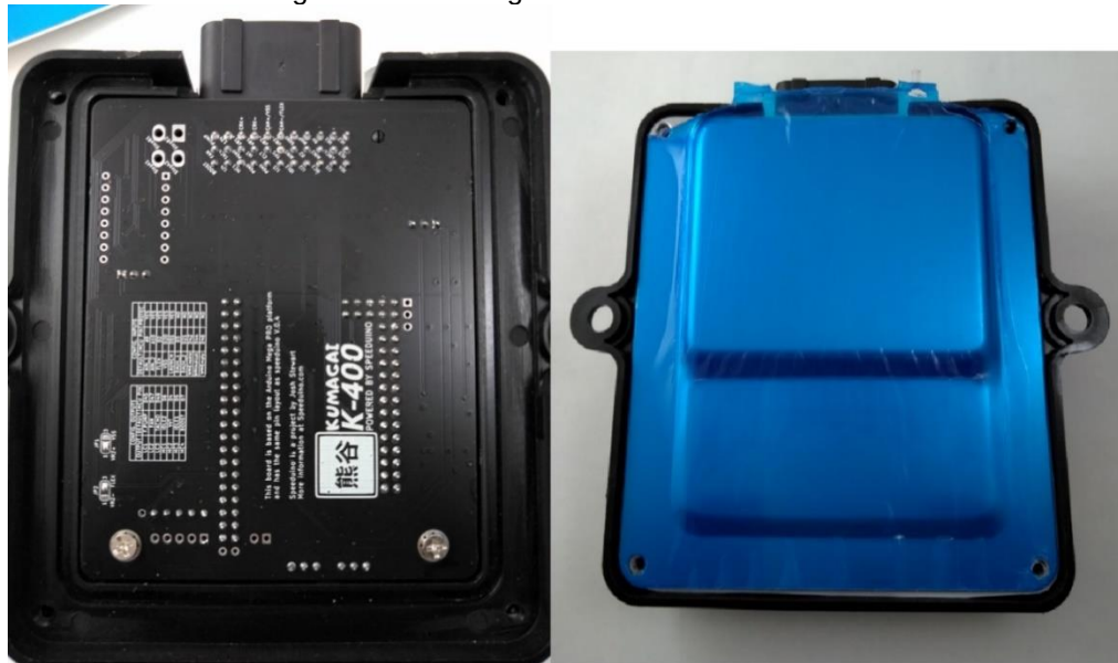
Figura 48 – Montagem na case. Vista inferior.
