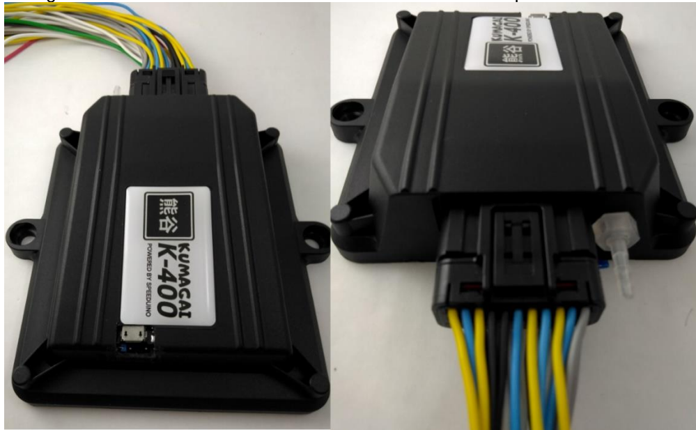
Figura 49 – ECU finalizada montada em case com chicote padrão automotivo.
